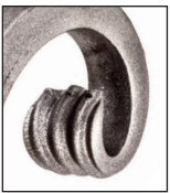
Hot forged ends Terminali fucinati a caldo
